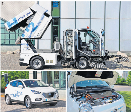
(1) La balayeuse CityCatH2, testée à Meyrin. (2) Hyundai ix35 Fuel Cell, premier véhicule à pile à combustible construit en grande série. (3) Le bloc de la pile à combustible de la Belenos. J.-M.C./DR
